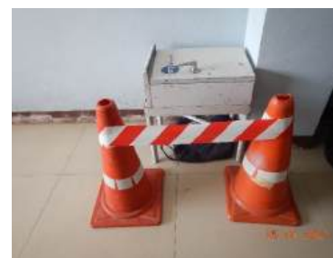
การติดตั้งเครื่องมือตรวจวัดคุณภาพอากาศ เสียง และความสั่นสะเทือน
