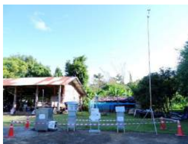
การติดตั้งเครื่องมือตรวจวัดคุณภาพอากาศ เสียง และความสั่นสะเทือน
