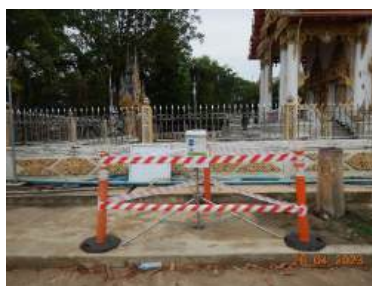
การติดตั้งเครื่องมือตรวจวัดคุณภาพอากาศ เสียง และความสั่นสะเทือน
